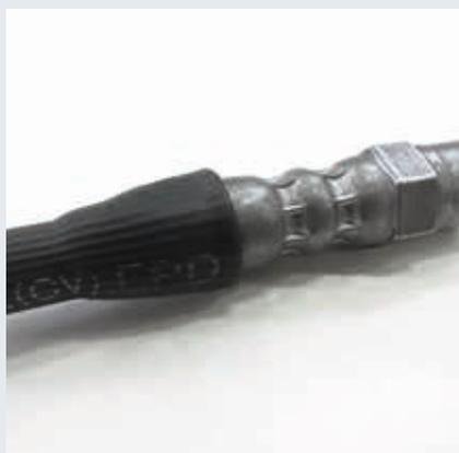
**Boursofflement au niveau de la jonction entre l'armature et le flexible textile**
