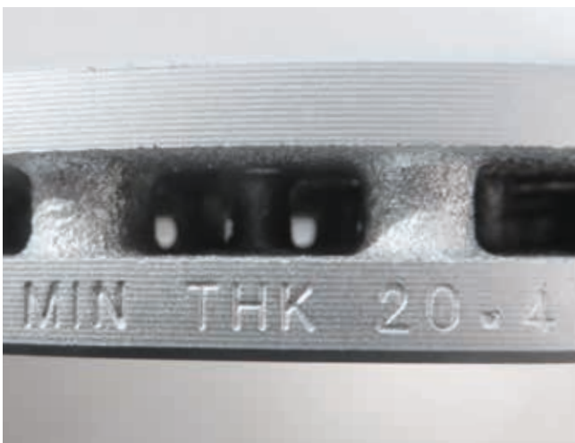
Indicazione dello spessore minimo sul bordo del disco freno
