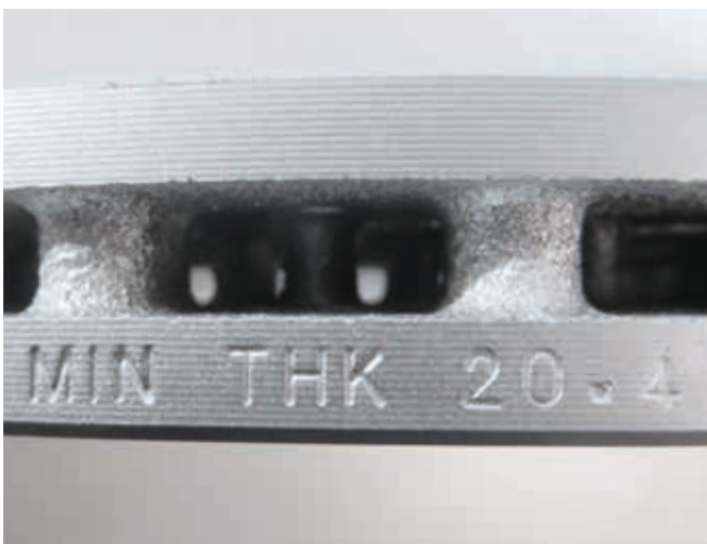
Angabe der Mindeststärke auf dem Rand der Bremsscheibe
