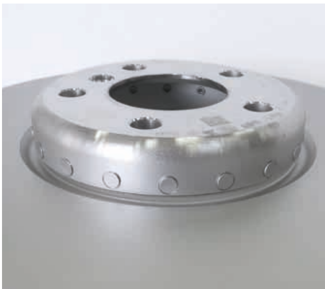
BMW Verbundbremsscheibe mit genietetem Aluminium Scheibentopf
