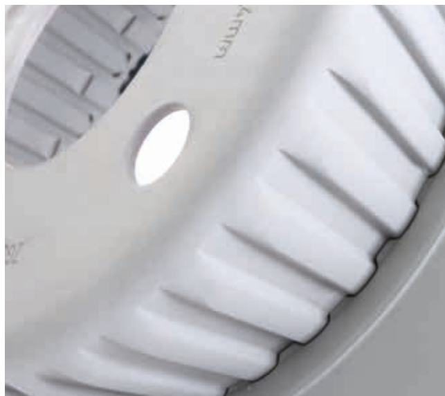
Mercedes Benz Bremscheibe mit verzahnten Stahlblech Scheibentopf
