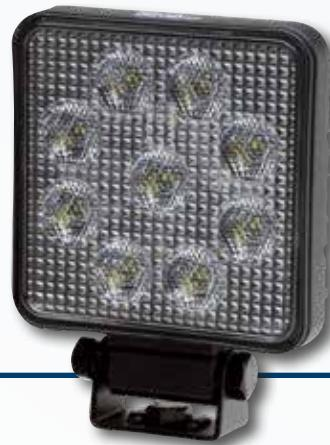
Montagem em pé ou suspensa, multivoltagem 10–30 V, 9 LEDs, consumo de energia 9 W, eficiência luminosa 1000 lm, tipo de proteção IP 6K7 / IP 6K9K, homologação ECE-R10, cabo de ligação de 800 mm
