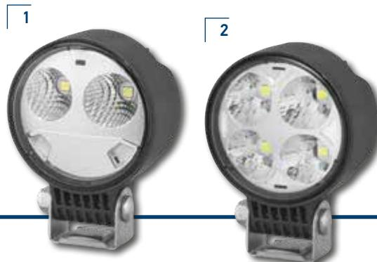
Montagem em pé ou suspensa, multivoltagem 9–32 V, tipo de proteção IP 6K7 / IP 6K9K, homologação ECE-R10, CISPR 25 classe 5, conector DT DEUTSCH, corpo do farol em plástico
