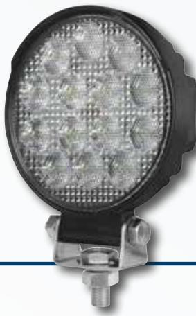
Montagem em pé ou suspensa, multivoltagem 10–30 V, 14 LEDs, consumo de energia 25 W, eficiência luminosa 2200 lm, tipo de proteção IP 6K9K, homologação ECE-R10, cabo de ligação de 800 mm
