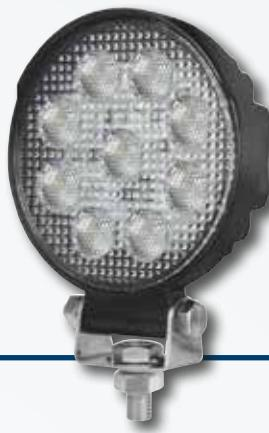
Montagem em pé ou suspensa, multivoltagem 10–30 V, 9 LEDs, consumo de energia 15 W, eficiência luminosa 1500 lm, tipo de proteção IP 6K9K, homologação ECE-R10, cabo de ligação de 800 mm
