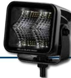
Montagem em pé ou suspensa, multivoltagem 10–30 V, consumo de energia 20 W, eficiência luminosa 1400 lm, tipo de proteção IP 68 / IP 69K, com ensaio de tipo ECE: ECE-R10, ligação com cabo de 500 mm e conector DT DEUTSCH
