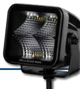
Montagem em pé ou suspensa, multivoltagem 10–30 V, consumo de energia 40 W, eficiência luminosa 3000 lm, tipo de proteção IP 68 / IP 69K, com ensaio de tipo ECE: ECE-R10, ligação com cabo de 500 mm e conector DT DEUTSCH
