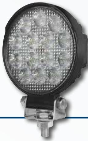
Montaggio verticale oppure sospeso, multitensione 10 – 30 V, 14 LED, potenza assorbita 25 W, resa luminosa 2.200 lm, classe di protezione IP 6K9K, omologazione ECE-R10, cavo di collegamento di 800 mm
