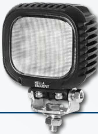
Montaggio verticale oppure sospeso, multitensione 10 – 48 V, 9 LED, potenza assorbita 30 W, resa luminosa 3.000 lm, classe di protezione IP 67 / IP 6K9K, omologazione ECE-R10, connettore DEUTSCH DT, cavo di 800 mm incluso
