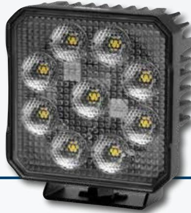
Montaggio verticale oppure sospeso, multitensione 10 – 30 V, 9 LED, potenza assorbita 31 W, resa luminosa 3.000 lm, classe di protezione IP 6K7 / IP 6K9K, omologazione ECE-R10, cavo di collegamento di 800 mm, sistema di Thermo Management\*\*
