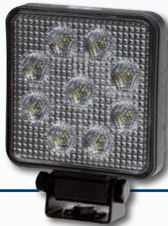
Montaggio verticale oppure sospeso, multitensione 10 – 30 V, 9 LED, potenza assorbita 9 W, resa luminosa 1.000 lm, classe di protezione IP 6K7 / IP 6K9K, omologazione ECE-R10, cavo di collegamento di 800 mm
