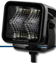
Montaggio verticale oppure sospeso, multitensione 10 – 30 V, potenza assorbita 20 W, resa luminosa 1.400 lm, classe di protezione IP 68 / IP 69K, omologato ECE: ECE-R10, cavo di collegamento di 500 mm con connettore DEUTSCH DT
