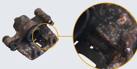
Boîtier endommagé, fixation du ressort cassée
