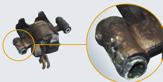
Douille de guidage endommagée
