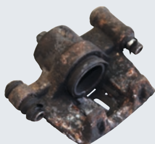
Oxydation interne. Piston de frein grippé Manchon endommagé
