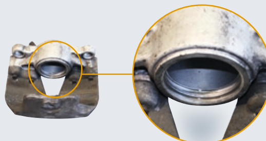
Absence du piston et du manchon de frein
