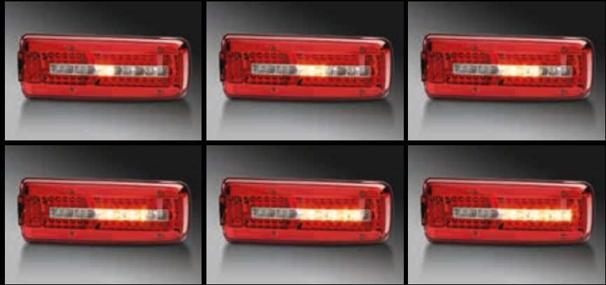
Anwendungsbeispiel für dynamisches Blinklicht
