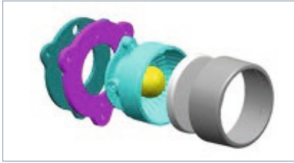
Aufbau der Leuchte mit Zierring und optionalem Schraubhalter zur Frontalmontage
