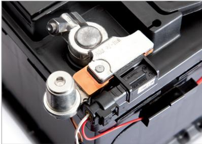
**Montage am Standard-Batteriepol**
