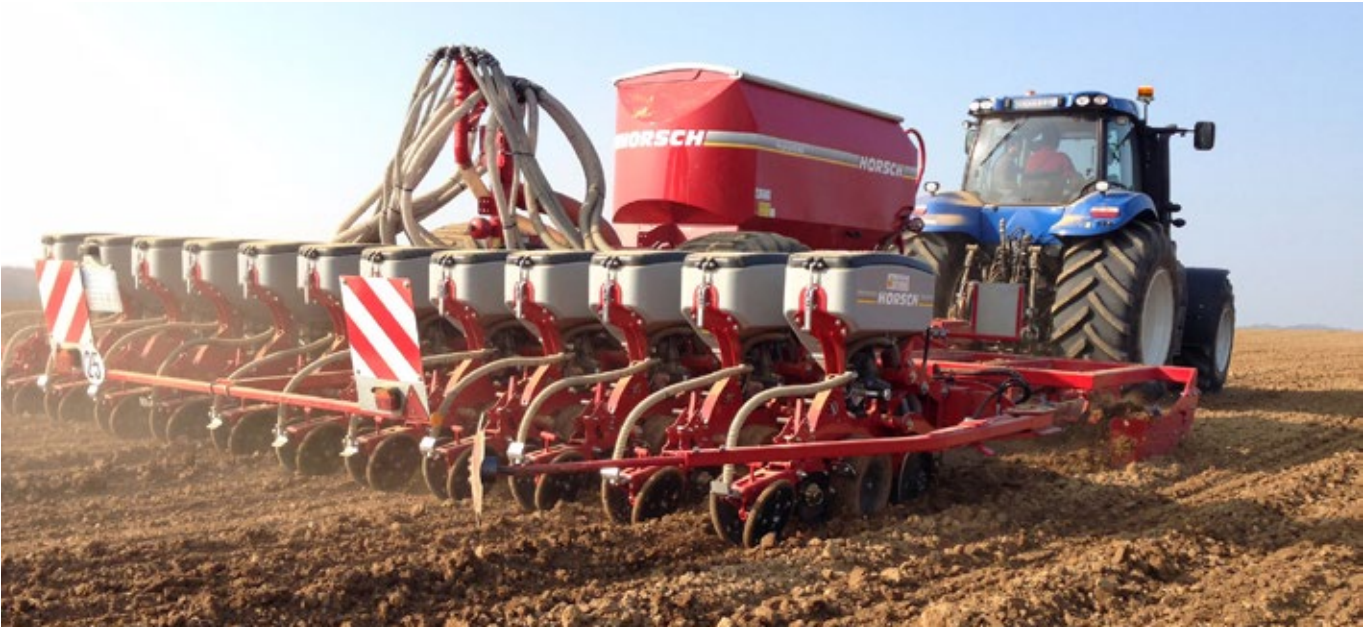
Saatgutdosierung/-vereinzelung Die CIPOS Technologie sowie ein hohes Drehmoment ermöglichen eine präzise und zuverlässige Positionierung.
