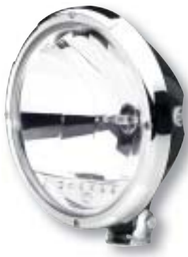
Anbau: Stehend. Neigungswinkel -45^\circ bis +90^\circ
