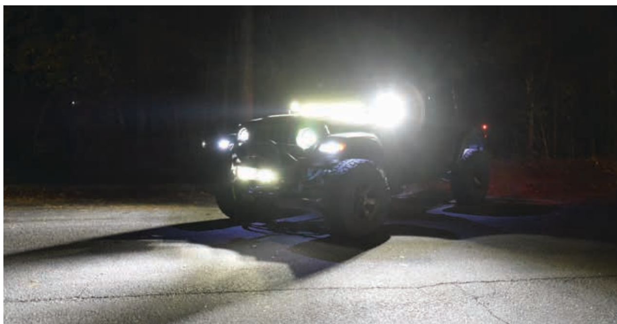
1) 2 x Black Magic Mini Lightbar : Montage sur support du pare-chocs avant
