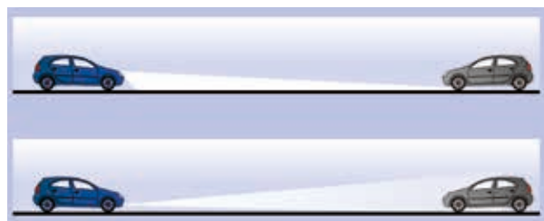
Abb.: Systemvergleich Abblendlicht gegenüber Tagfahrlicht
