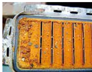
Ablagerung durch Ölaustritt kommt von Motoröl, das durch einen Zylinderkopfdichtungs-Schaden in den Kühlmittelkreislauf gelangt.
