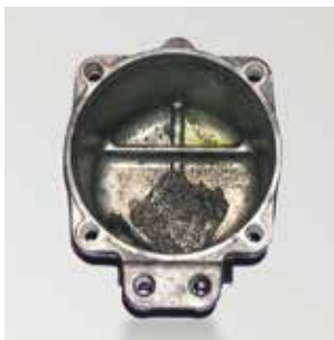
Abrieb bei Kompressorschaden
