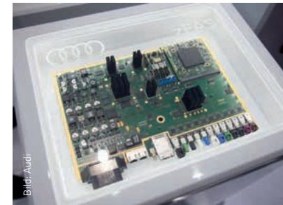
Im zentralen FAS-Steuergerät werden die Daten zahlreicher unterschiedlicher Sensoren und Kameras gesammelt und allen wichtigen Systemen zur Verfügung gestellt.
