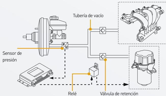
La bomba regulada lleva un sensor de presión que va montado en el conducto de vacío que llega hasta el servofreno. El sensor de presión registra constantemente la presión real del sistema y transmite este valor a una unidad de control superior (p.ej. a la unidad de control del motor).
