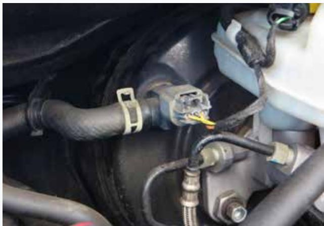
A continuación, la diagnosis se realizará, a modo de ejemplo, en un Opel Cascada 1,4i 16V Turbo, del año 2013 con un equipo de diagnosis mega macs 77, aunque puede realizarse de la misma manera en vehículos de similar construcción. Este vehículo, equipado con turbocompresor y sistema STOP-START, lleva una bomba de vacío HELLA UP28 con sensor de presión en el servofreno.
