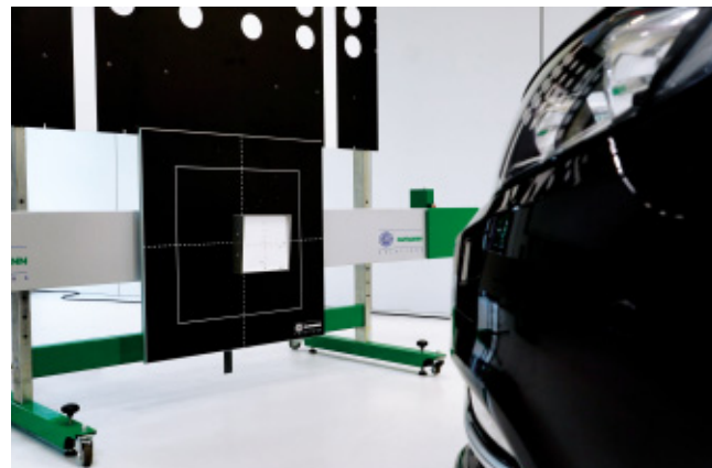
Hoekverstelpaneel voor radarsystemen van diverse fabrikanten
