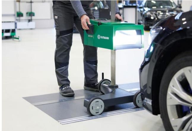
**Komfortable Höhenverstellung.** Beidhändige Führung über Handgriffe erleichtert die vertikale Ausrichtung des Geräts.
