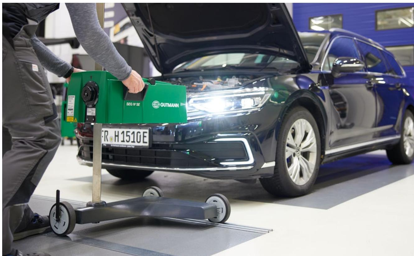
Gutes Know-how des Bedieners hinsichtlich der Fahrzeugmodelle und Lichtsysteme vorausgesetzt, lassen sich auch an modernen LED-Matrix-Scheinwerfern Auswertungen von Lichtverteilungen und fachgerechte Einstellungen vornehmen. Die feine, vertikale Skalierung auf dem Prüfschirm ermöglicht zudem das Prüfen und Einstellen von Scheinwerfersystemen mit Fernlichtassistent.
