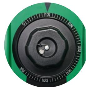
**Prüfschirmverstellung.** Mittels Skalenrad lässt sich der Prüfschirm feinfühlig und exakt auf den gewünschten Wert einstellen.
