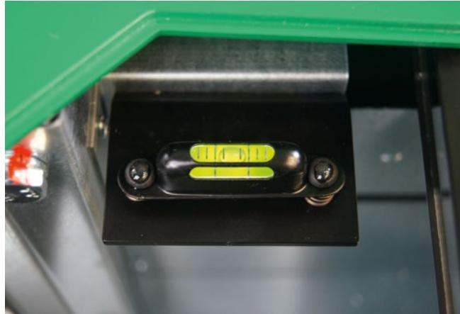
**Wasserwaage.** An der Exzenterachse können von der Libelle angezeigte Bodenunebenheiten bzw. Neigungen ausgeglichen werden.
