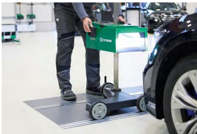
**Réglage en hauteur confortable** avec les 2 mains à partir d'une manette à frein.
