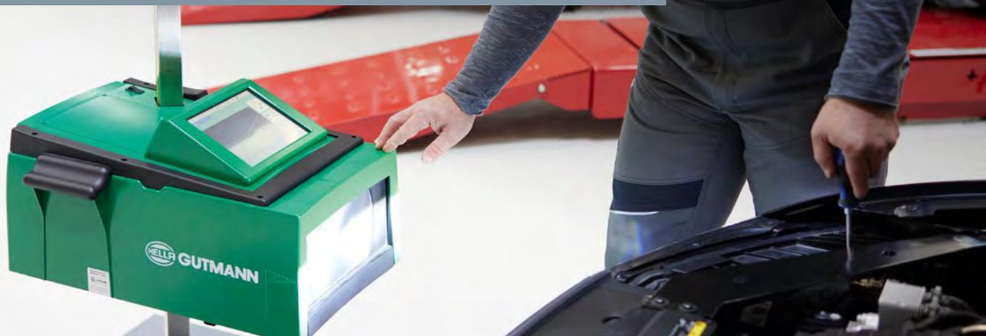
La preuve en image. Durant le réglage de la diffusion de lumière, les actions effectuées sur les commandes de réglage apparaissent immédiatement sur l'écran. Pour actionner les vis de réglage, SEG fournit des indications de réglage. Grâce aux lignes de références et de tolérances, le travail est efficace jusqu'à obtenir un résultat parfait.
