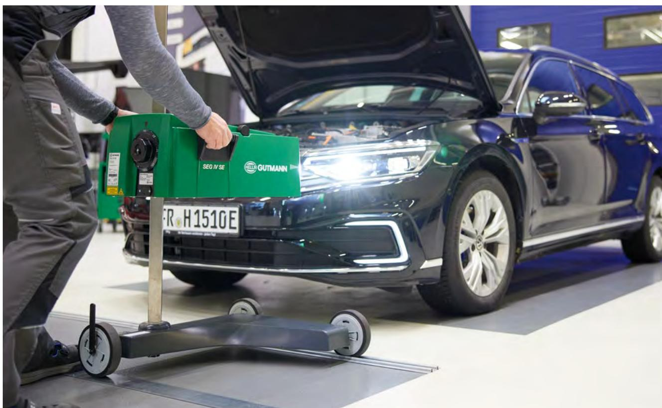
Un technicien bien formé sur le modèle et le système d'éclairage en question sera en mesure d'évaluer la diffusion de lumière et d'effectuer des réglages conformes même sur des systèmes modernes tel que les projecteurs Matrix LED. Les graduations verticales fines sur l'écran de contrôle permettront même de contrôler et de régler des systèmes d'éclairage avec assistant des feux de route.
