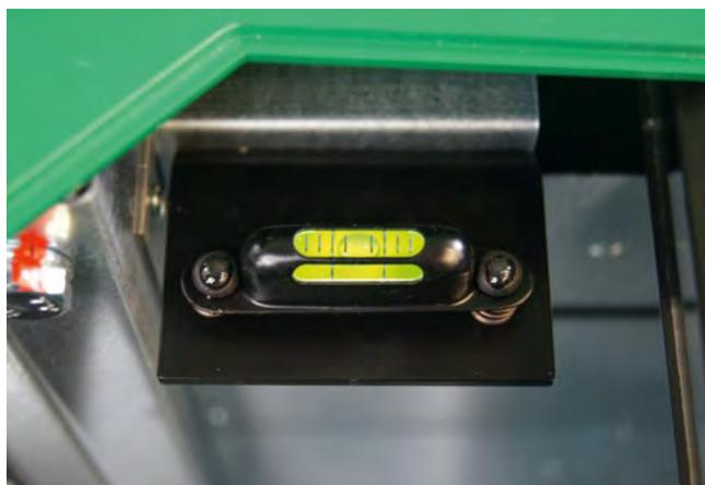
**Niveau à bulle.** L'axe à excentrique permet de corriger les défauts de planéité et d'inclinaison indiqués par le niveau à bulle.
