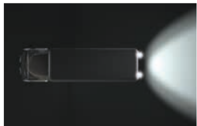
Variante A: duas luzes de marcha-atrás adicionais na traseira.
