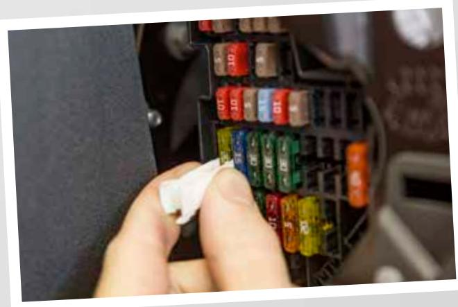
Retire el fusible para el circuito "Bocina de señalización" de la caja de fusibles para interrumpir la alimentación de tensión de los dispositivos de señalización acústicos durante el periodo de la conexión eléctrica.
