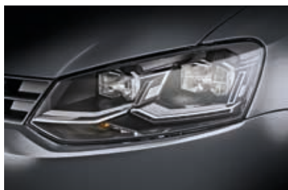
Kleinwagen / VW Polo (2014): LED-Frontscheinwerfer mit Reflektorsystem für Abblend- und Fernlicht
