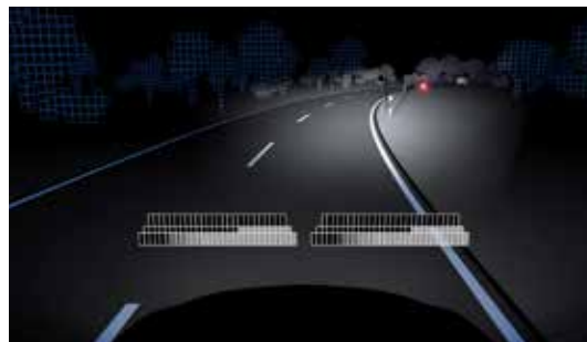
Automatische Gefahrenerkennung, weltweit erstes rein elektronisches Kurvenlicht in der Abblendlichtfunktion
