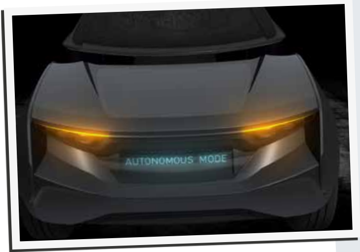
Für die Frontbeleuchtung lässt sich Holografie ebenfalls nutzen – auch in Kombination mit anderen Technologien wie dem LED-Matrix-Display (Schriftzug „Autonomous Mode“).
