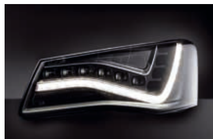
Attraktive Styling- und Lichtsignaturmöglichkeiten dank LED-Technik (Beispiel: Audi A8 Voll-LED-Scheinwerfer)
