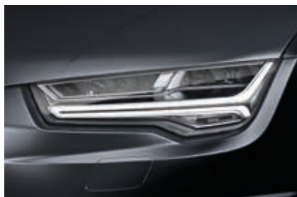
Kompaktklasse / Renault Kadjar (2015): LED-Frontscheinwerfer mit HELLA Mono- LED-Modulen für Abblend- und Fernlicht
