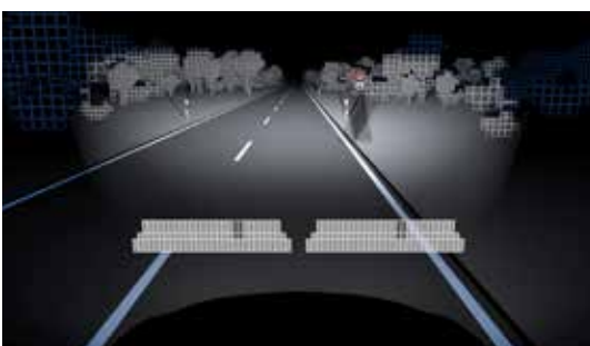
Verkehrsschilderkennung mit Reduzierung der Eigenblendung
