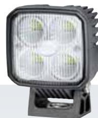
LED-Rückfahrcheinwerfer, Anbau stehend oder hängend, Multivolt 9 – 32 V, 4 LEDs, Leistungsaufnahme 15 W, Lichtleistung 1.200 lm, Schutzart IP 6K9K / IP 6K7, ECE-R10 und ECE-R23 Zulassung, CISPR 25 Klasse 5, wärmeleitendes Kunststoffgehäuse
