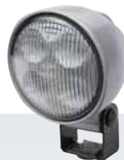
LED-Rückfahrscheinwerfer, Anbau stehend / hängend, Multivolt 9–32 V, 4 LEDs, Leistungsaufnahme 13 W, Lichtleistung 800 lm, Schutzart IP 6K9K, IP 6K7, ECE-R10 und ECE-R23 Zulassung, CISPR 25 Klasse 5, grau bepulvertes Aluminiumgehäuse
