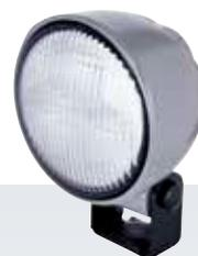
LED-Rückfahrscheinwerfer, Anbau stehend / hängend, Multivolt 9–32 V, 3 LEDs, Leistungsaufnahme 20 W, Lichtleistung 1.800 lm, Schutzart IP 6K9K, IP 6K8, ECE-R10 und ECE-R23 Zulassung, CISPR 25 Klasse 5, Aluminiumdruckgussgehäuse mit CoroSafe Beschichtung
