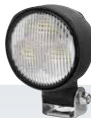
LED-Rückfahrscheinwerfer, Anbau stehend / hängend, Multivolt 9–32 V, 12 LEDs, Leistungsaufnahme 13 W, Lichtleistung 1.500 lm, Schutzart IP 6K9K, IP 6K8, ECE-R10 und ECE-R23 Zulassung, CISPR 25 Klasse 5, korrosionsfreies Kunststoffgehäuse
