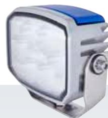
LED-Rückfahrcheinwerfer, Anbau stehend oder hängend, Multivolt 9 – 32 V, 6 LEDs, Leistungsaufnahme 14 W, Lichtleistung 850 lm, Schutzart IP 6K9K, IP 6K8, ECE-R10 und ECE-R23 Zulassung, CISPR 25 Klasse 5, Aluminiumgehäuse
