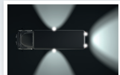
Wersja C: dwa dodatkowe reflektory świateł cofania z tyłu plus po jednym dodatkowym reflektorze światła manewrowego z boku.
