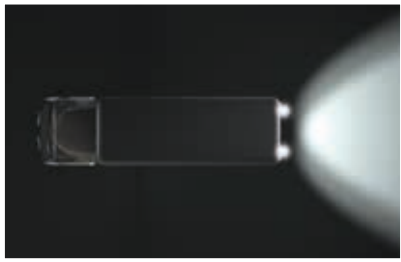
Variante A: dos faros de marcha atrás adicionales en la parte trasera.
