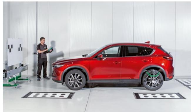
Ein typisches Umfeldkamerasystem besteht aus vier Kameras mit breitem Erfassungswinkel. Aus ihren Bildern wird ein lückenloses Rundum-Abbild der Fahrzeugumgebung zusammengesetzt. Dieses bildet die Basis für ADAS wie z. B. Kreuzungsassistent, Parkassistent, Ausstiegswarner, Totwinkelerkennung und Stauassistent. Auch bei diesen Kameras ist eine exakte Positionierung zum Fahrzeug erforderlich.
