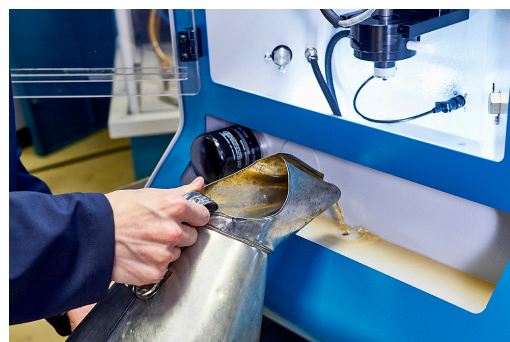
Bei den Tests muss die korrekte Schutzflüssigkeit ISO4113-AW2 verwendet werden
