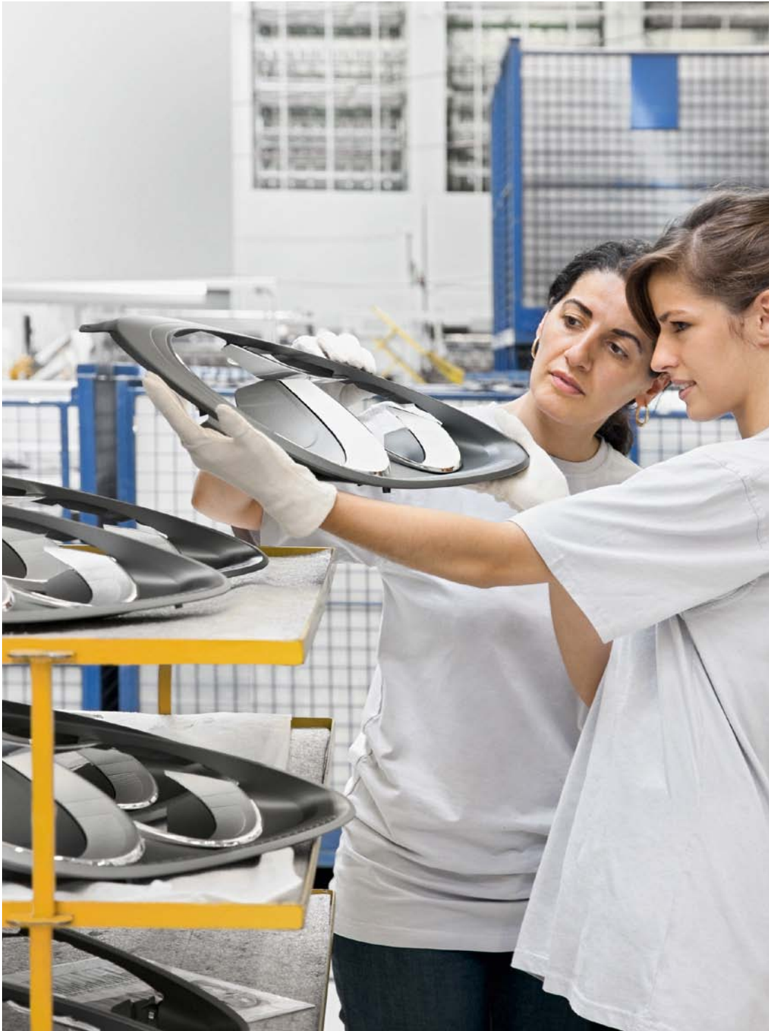
Scheinwerferabdeckrahmen werden vor der Weiterverarbeitung auf ihre Qualität hin überprüft
