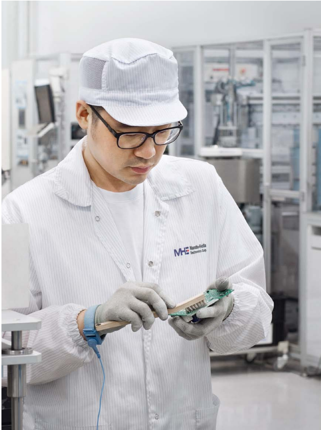
Nach dem Lötén der elektrischen Lenkunterstützung werden überschüssige Materialien von der Platine gebürstet
