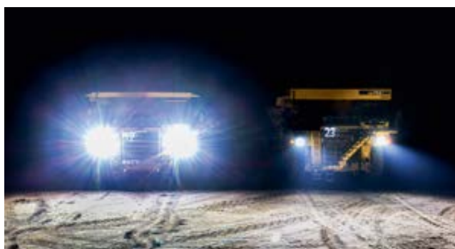
Comparativa iluminación tradicional (izq.) e iluminación ZEROGLARE (der.)
