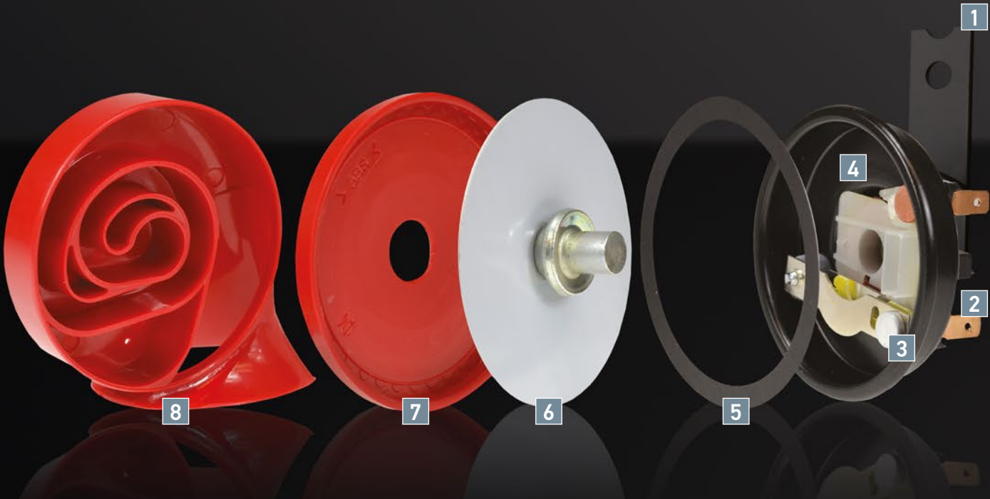
[1] Suporte [2] Terminais [3] Contatos [4] Solenóide [5] Vedação [6] Diafragma [7] Placa de suporte [8] Solenóide
