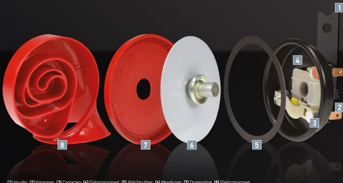
[1] Houder [2] Klemmen [3] Contacten [4] Elektromagneet [5] Afdichtrubber [6] Membraan [7] Dragerplaat [8] Elektromagneet
