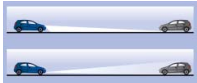
Abb.: Systemvergleich Abblendlicht gegenüber Tagfahrlicht
