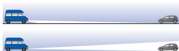
Abb.: Systemvergleich Ablendlicht gegenüber Tagfahrlicht
