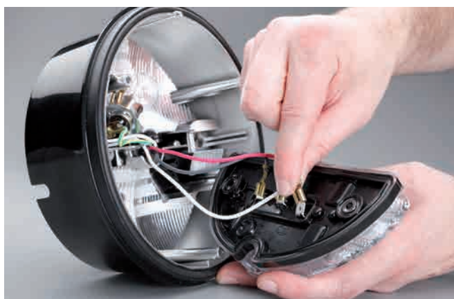
Schritt 4: LED-Modul mit den Flachsteckhülsen kontaktieren. Bitte die richtige Pin-Belegung und Reihenfolge beachten: Schwarz = Schlusslicht, Rot = Bremslicht, Weiß = Masse
