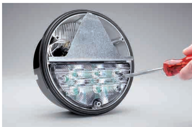
Schritt 5: Zunächst die Farbtrennwand wieder einsetzen und anschließend das LED-Modul mit 2 Schrauben befestigen Schritt 6 (nicht dargestellt): Lichtscheibe wieder montieren
