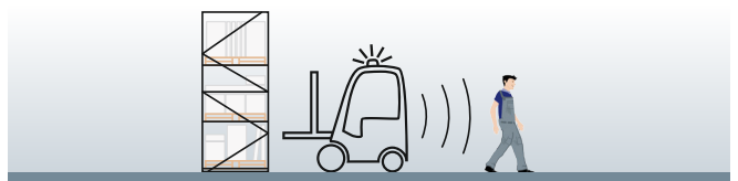
Anti Kollision sowie Erkennung von bewegten Objekten, die den Weg kreuzen
