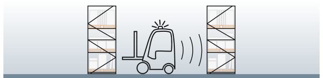
Anti Kollision mit stehenden Objekten wie Regalen, Fahrzeugen oder anderen Hindernissen
