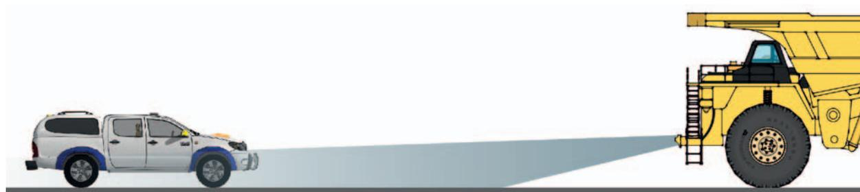
Die ZEROGlare Optik erzeugt eine blendfreie Ausleuchtung. Entgegenkommende Fahrzeuge werden nicht geblendet.
