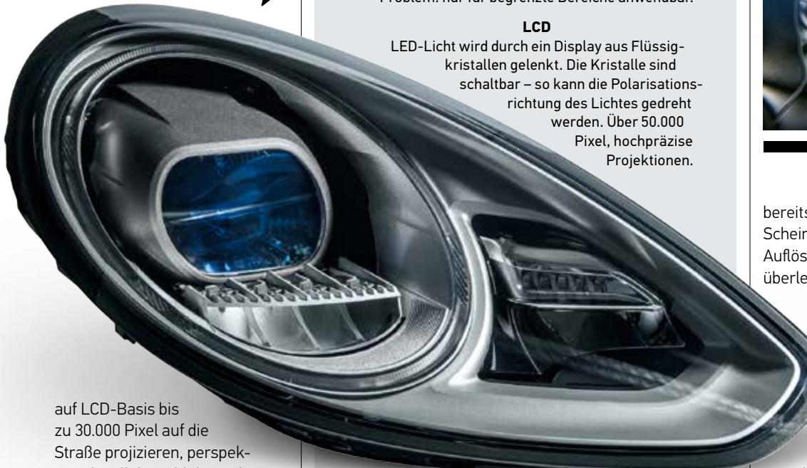
auf LCD-Basis bis zu 30.000 Pixel auf die Straße projizieren, perspektivisch soll die Zahl der Lichtpunkte auf über 50.000 ausgebaut werden. Die Frage, die es gemeinsam zu klären galt: Lässt sich durch die Kombination von LEDs und einem Flüssigkristall-Display, wie es zum Beispiel von Flachbildfernsehern her bekannt ist, ein Scheinwerfer konstruieren, der intelligent, stufenlos und zielgerichtet verschiedenste Fahrsituationen meistern kann? Und dabei den
