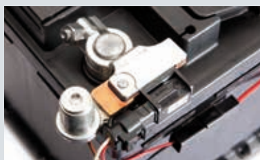
Montage am Standard-Batteriepol (Batteriepol-Adapter nicht im Lieferumfang enthalten)
