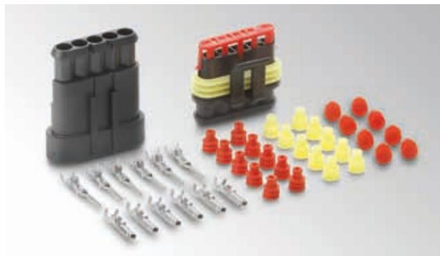
Entsprechen den Vorschriften der IEC 529 sowie der DIN ISO 40050 und verfügen über die IP Klasse 67, welche maximalen Schutz vor Wasser- und Staubeintritt garantiert. Aufgrund ihrer Beschaffenheit sind die „SUPERSEALS“ überall dort besonders geeignet, wo andere Verbindungssysteme aufgrund von widrigen Druck- oder Feuchtigkeitsverhältnissen an ihre Grenzen stoßen.
