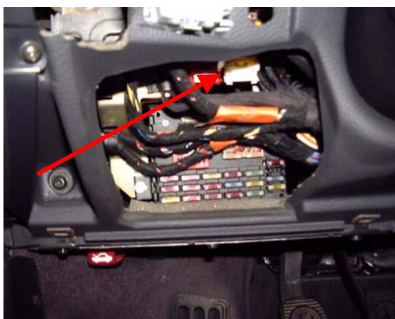
Figure 1 : Fusible ABS : Sous le tableau de bord à gauche, à côté de la colonne de direction (Conduite à gauche)
