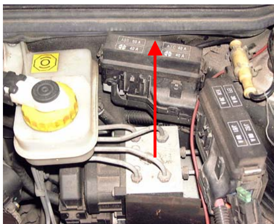
Figure 2 : Fusible principal ABS : A côté du réservoir de liquide de frein (Conduite à gauche)
