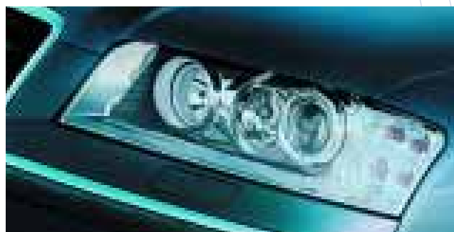
Weltweit erster zugelassener Scheinwerfer mit serienmäßigem Abbiegelicht als Vorstufe zum intelligenten Scheinwerfersystem VARILIS ® für den neuen Audi A8.
