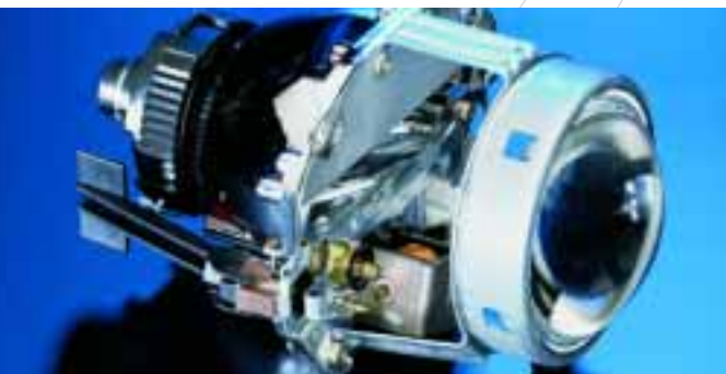
Scheinwerfer mit Bi-Xenon-Modul. Abblendlicht und Fernlicht mit nur einer Xenon-Lampe.
