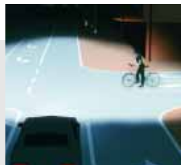
Weltweit erster zugelassener Scheinwerfer mit serienmäßigem Abbiegelicht als Vorstufe zum intelligenten Scheinwerfersystem VARILIS ® für den neuen Audi A8.
