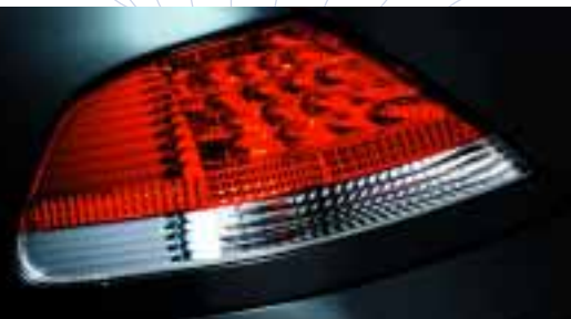
Die 7er-Reihe verfügt über insgesamt 74 LEDs im Heck.
