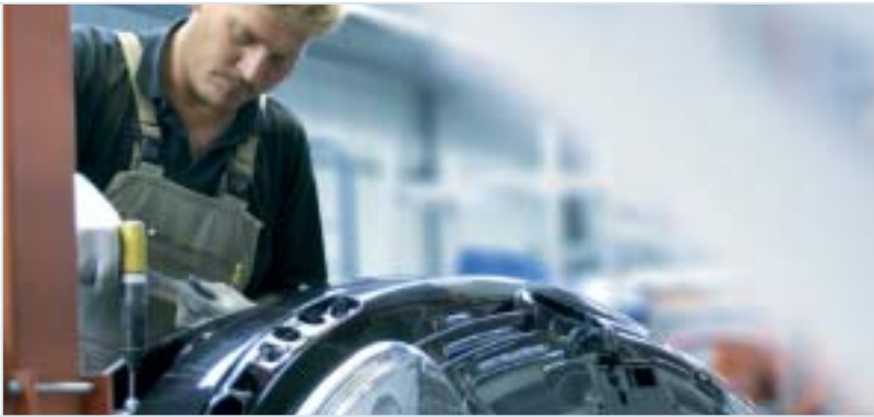
Spezialist in Meerane montiert ein Frontendmodul.
