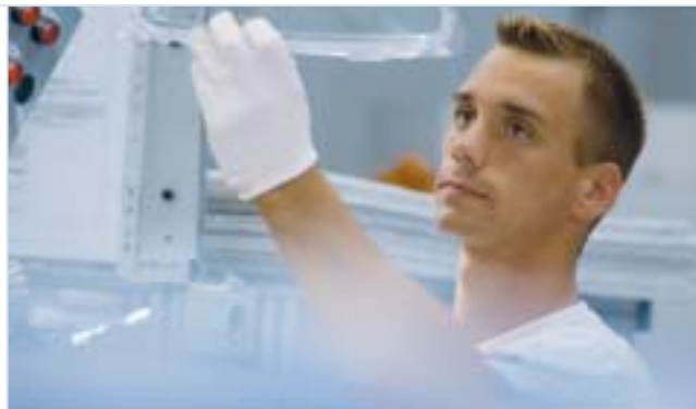
Letzter optischer Check einer Kunststoff-Abschlusscheibe.
