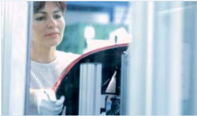
Lichttechnische Endprüfung einer Signalleuchte bei MAESA in Spanien.
