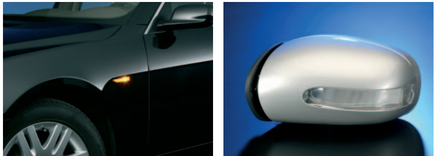
Bauformen vorderer Blinkleuchten/Seitenmarkierungsleuchten
