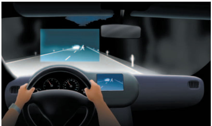
Darstellung des Kamerabilds auf einem Head-Up-Display/Dashboard-Display
