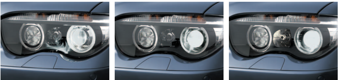
Aktuelles Hella-Versuchsfahrzeug mit variablem intelligentem Lichtsystem VARILIS®
