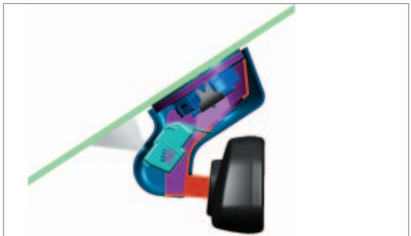
Schnittdarstellung Spiegelfuß mit integriertem Thermopilesensor und Regen-/Licht-Sensor
