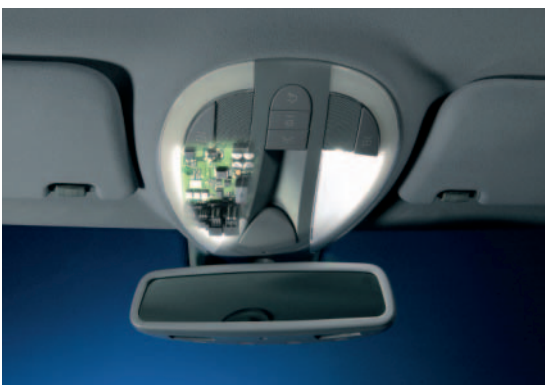
Dachbedienzentrum mit Elektronik
