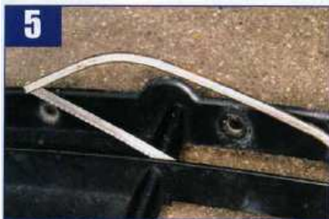
5 Gegebenenfalls verschlossene Bereiche aus-sägen, so dass die LED-Leuchte ohne Luft passt
