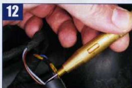
12 Am Stecker für Standlicht mit Prüfspitze die Plus-Leitung ausmessen (siehe Text)
