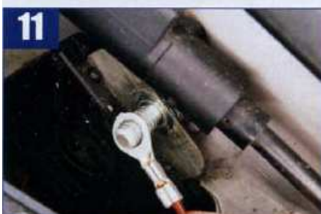
11 Masse-Öse vom Bausatz auf Gewinde auf-stecken, Mutter wieder aufdrehen
