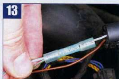
13 Graue Leitung vom Hella-Bausatz an Standlicht-Plus anschließen, schwarz an Zündungs-Plus
