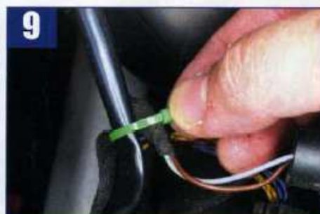
9 Leitungsstrang in kurzen Abständen mit Kabelbin-dern sichern und nach oben führen
