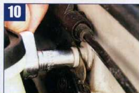
10 Seitlich am Kotflügel die Mutter der Masse-schraube lösen und ggf. säubern
