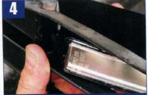
Mit etwas Glück passen die flachen Tagfahrleuchten zwischen zwei Lamellen der Luftgitter
