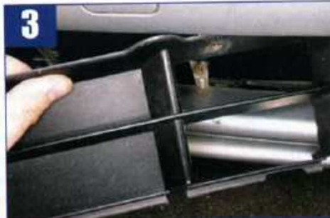
Gitterblende aus Stoßfänger entrasten und mit der Hand nach vorn heraus ziehen
