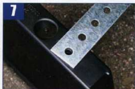
7 ... mit Lochseisen an den hinteren Sacklöchern für selbstschneidende Schrauben befestigt
