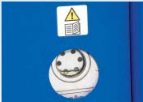
A vákuumszivattyú-olaj szintjének egyszerű ellenőrzése
