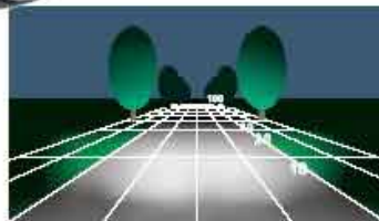
GE Nahfeldausleuchtung Straßenbreite 6 m
